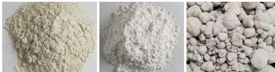
CO<sub>2</sub>固定型混和材    CCU微粉    CCU骨材
