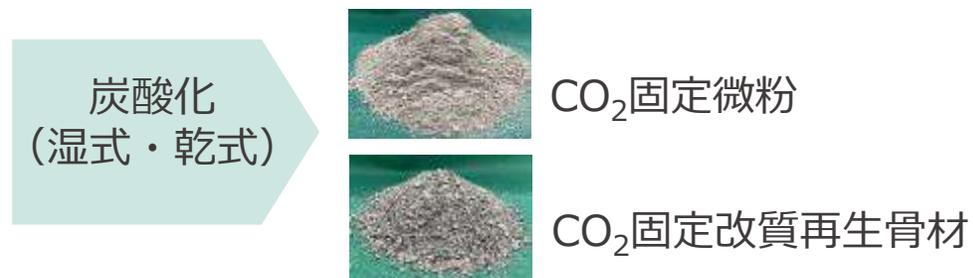
廃コンクリートから製造した再生骨材・再生微粉に効率的にCO<sub>2</sub>を固定し、新しいCCU材料として再利用
