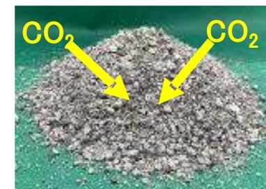
CO<sub>2</sub>固定細骨材(CS)
